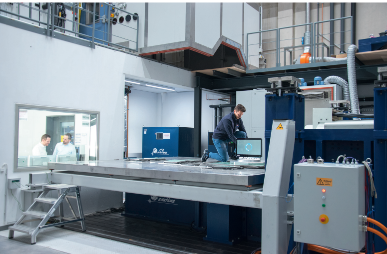
Bild 1: Eine der modernsten Vibrationsanlagen Deutschlands: Auf dem 300-kN-Shaker können Prüflinge bis zu 3 Tonnen getestet werden.
